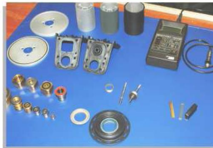
Eine (fast) unmögliche Verbindung – Haftung mit Gewähr Metalle und Kunststoffe mit Elastomeren (Gummi) zu hybriden Verbundteilen durch Montagespritzen zu paaren setzt feinjustierte Verfahrensschritte und viel Erfahrung voraus – bei Gummi Hoffmann in Kirchheim Teck beherrscht man diese Produktionsverfahren - die Ergebnisse liegen auf dem Tisch: 2-K- Hart-Weich-Teile aus Kunststoff und Elastomer, Metallteile mit Gummi-Komponente
