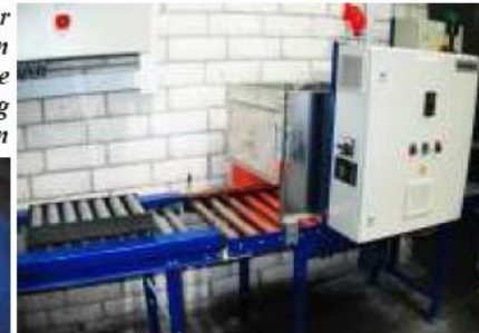
Es kommt auf die Sekunde an ... bei einem schönen Teil. Das genaue Aufheizen und sorgfältige Temperieren ist wichtig, damit Primer und Haftvermittler Gummi mit Metall „haftbar“ verbinden
