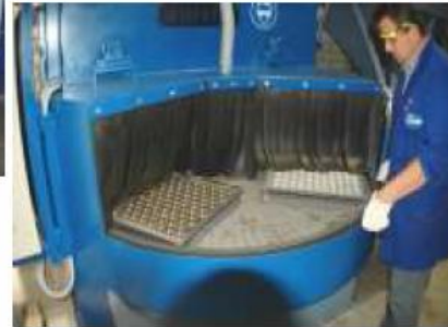
Sorgfältige Vorbereitung für eine dauerhafte Bindung: Eine sorgfältige Vorbereitung der Metallteile ist für die Produktion haltbarer, hybrider Verbundteile aus Metall und Elastomer unerlässlich
