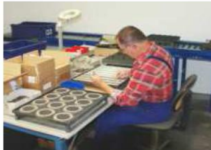
Sorgfältige Vorbereitung für eine dauerhafte Bindung: Eine sorgfältige Vorbereitung der Metallteile ist für die Produktion haltbarer, hybrider Verbundteile aus Metall und Elastomer unerlässlich
