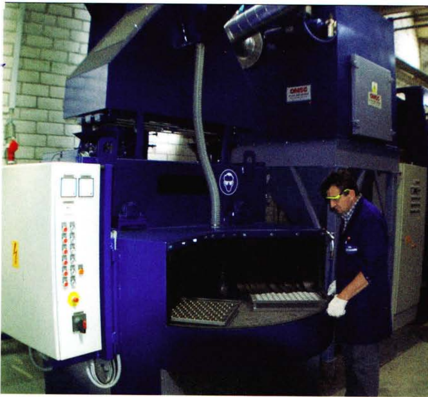
In Strahlanlagen von Wurster und Schlick wird die Metalloberfläche aufgeraut. (Bilder: Trapp)
