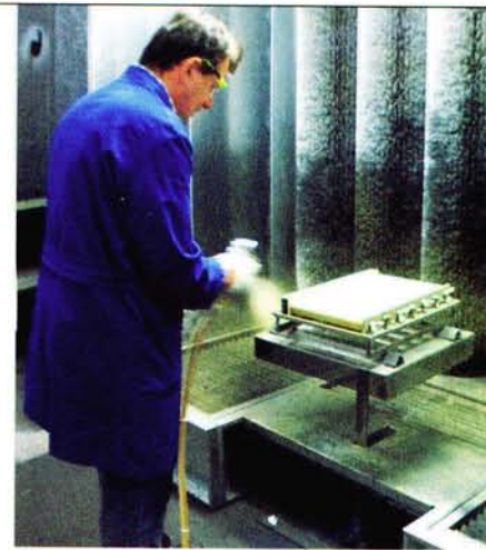
Primer und Haftvermittler müssen gleichmäßig und in den richtigen Schichtdicken aufgetragen werden.
