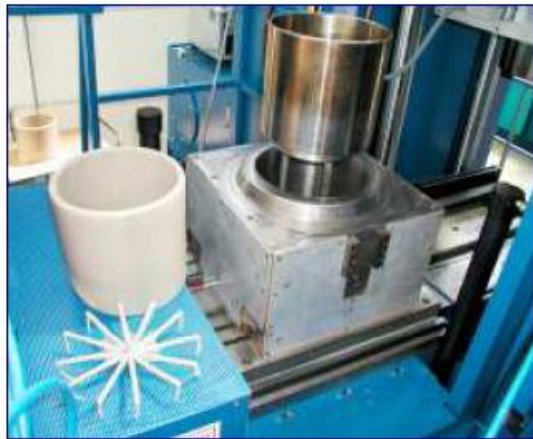
Großanlage für große Teile im XXL-Format: Bis zur Eimergröße können Elastomerteile bei Gummi-Hoffmann im schwäbischen Kirchheim unter Teck produziert werden
